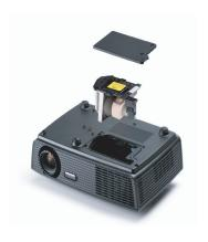
**9** OSD **ランプ**タブにある**ランプリセット**で「はい」を選択して、ランプ使用 時間をリセットします (ページ 34の[ランプ]メニューを参照してくださ い)。新しいランプモジュールを変更すると、プロジェクタはランプ時間を 自動的に検出しリセットします。
